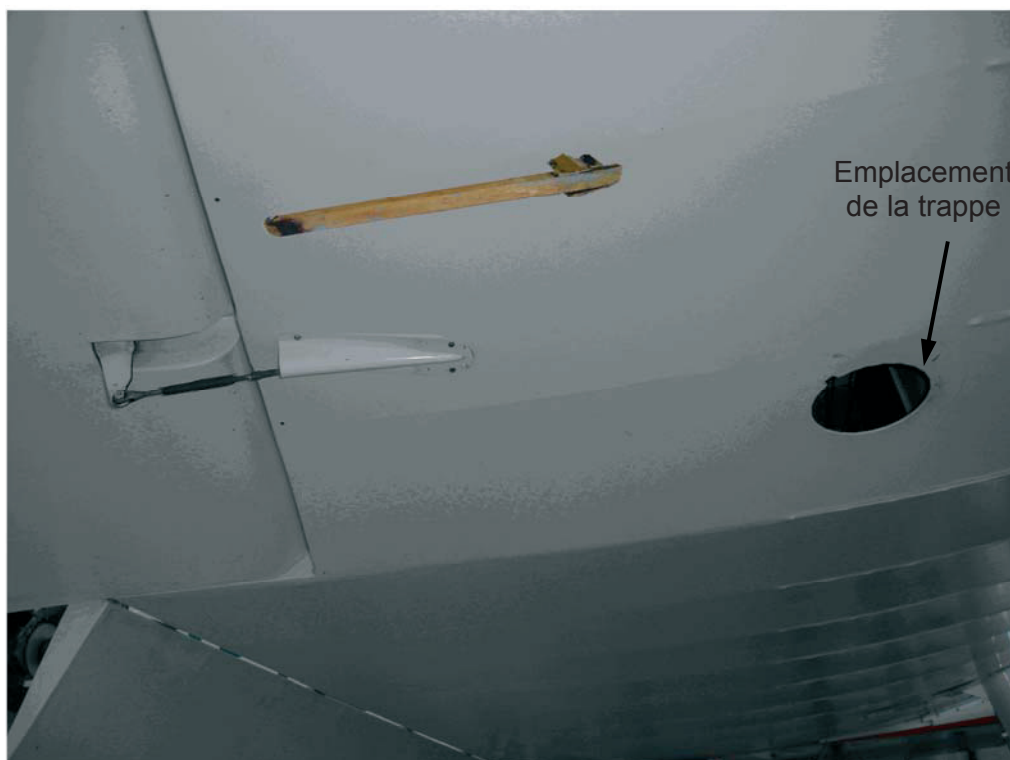
Positionnement sur une aile de D 140 des morceaux retrouvés
