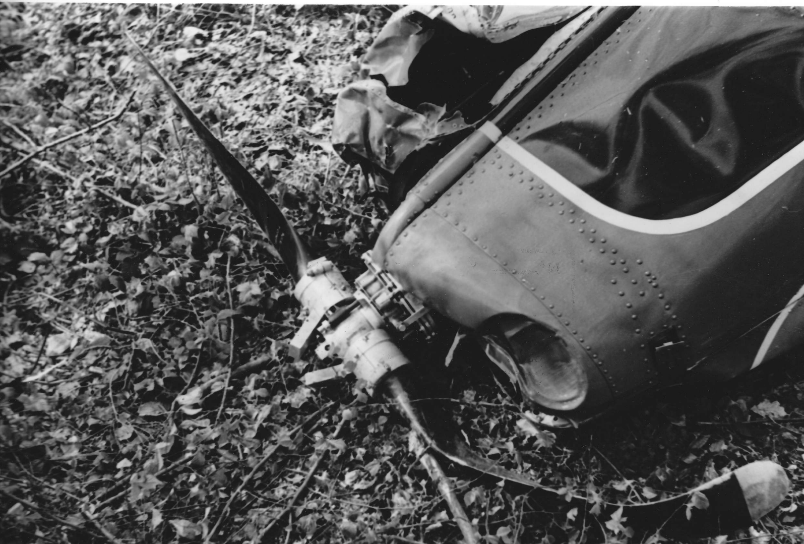
HELICE ET MOTEUR INDIQUANT LES TRACES DES POINTS D'IMPACT AVEC L'ARBRE
