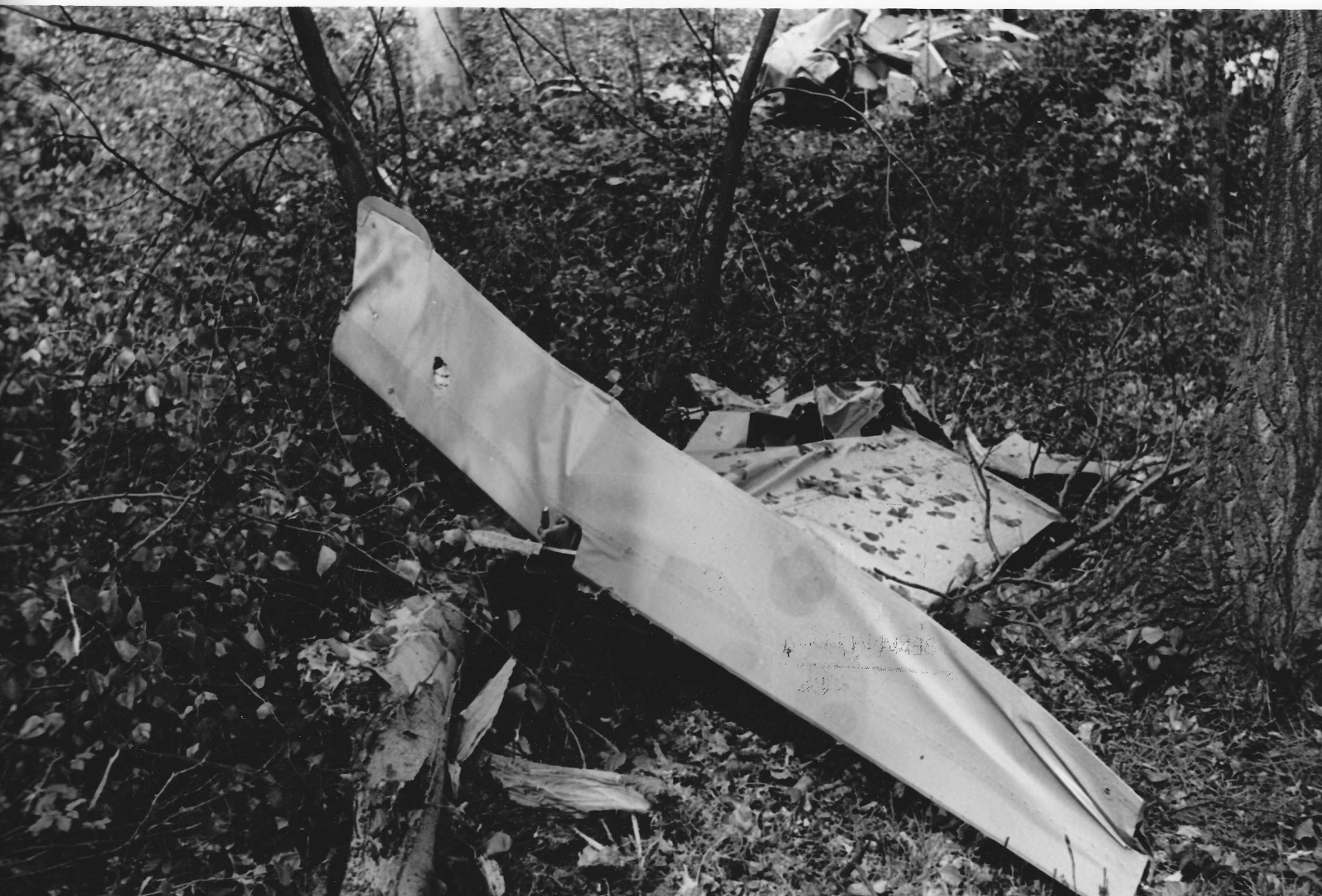
MORCEAU D'AILE DROITE AVEC AILERON DROITE ENTREMELES A LA CIME DE L'ARBRE
