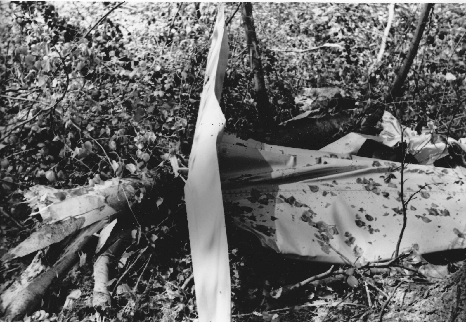
MORCEAU D'AILE DROITE AVEC AILERON DROITE ENTREMELES A LA CIME DE L'ARBRE
