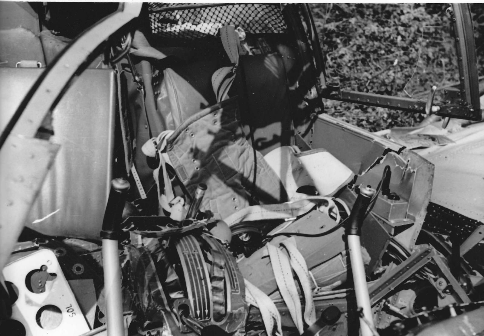
SIEGE DU PILOTE ET PARACHUTE, LEVIER DU TRAIN POSITION "UP", LEVIER DES FLAPS POSITION 20°.
